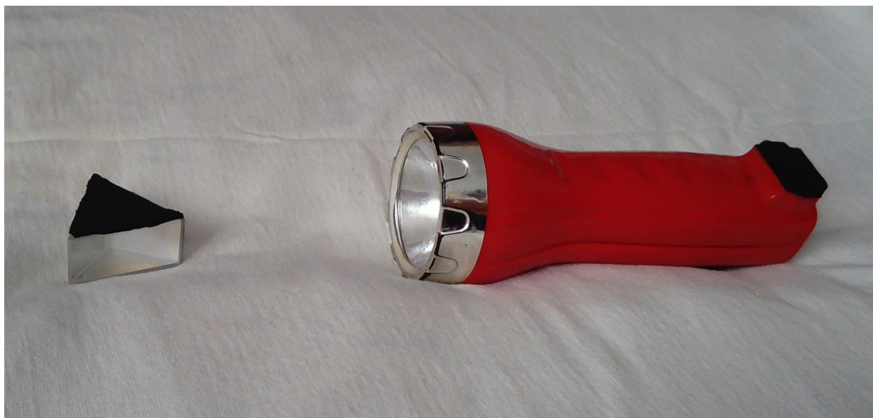
Фото 2. Ліхтарик з світлодіодною матрицею і скляна призма
